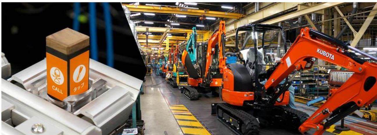
日本を代表する農業機械メーカー株式会社クボタの枚方製造所では、主に上下水道や産業インフラに使用されるポンプ、石油プラントに使われるバルブ、世界トップシェアを誇るミニバックホーの製造をしています。
